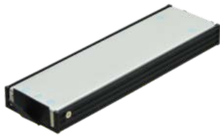
Быстросъемная корзина с SSD накопителем 256ГБ - 2ТБ PCIE
